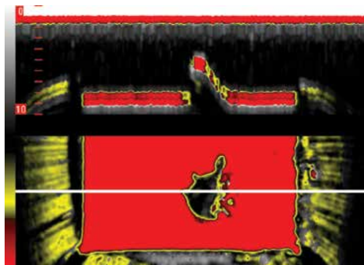
4 Поперечное сечение трещины в компаунде, полученное в режиме Q-ВАМ™
