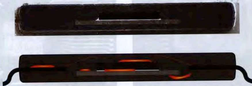
그림 1. 위 : 유형-1 TSOP 단면의 광학 현미경 사진이다. 아래 : 내부 패키지 불량이 빈번하게 발생하는 위치들을 보여준다. 컬러로 표시된 불량들은 왼쪽에서부터 순서대로, 성형 화합물과 리드 핑거 사이의 층 분리, 다이 패들과 성형 화합물 사이의 층 분리, 다이 접합부와 다이 사이의 층 분리, 다이 표면과 성형 화합물 사이의 층 분리, 납땀 균열이다.
