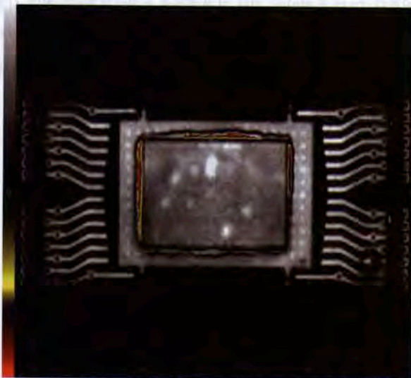
그림 2. TSOP의 C-SAM 음파 영상이다. 적색 및 황색 영역은 다이 주변에 중요한 부위에 발생한 층 분리를 의미한다.
